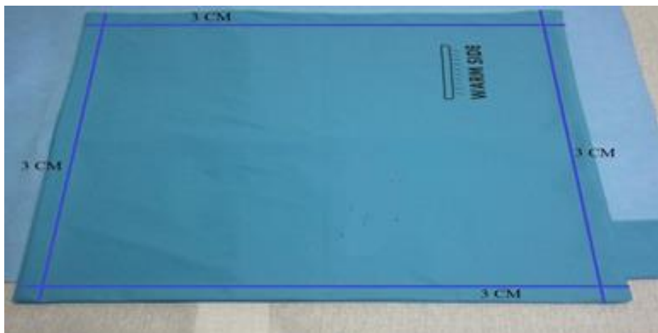
Bild 13 - Kaltbereiche der Heizpad's
